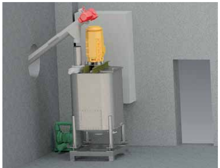
■ Verwiegung und Lösebehälter für Fertigmischung
