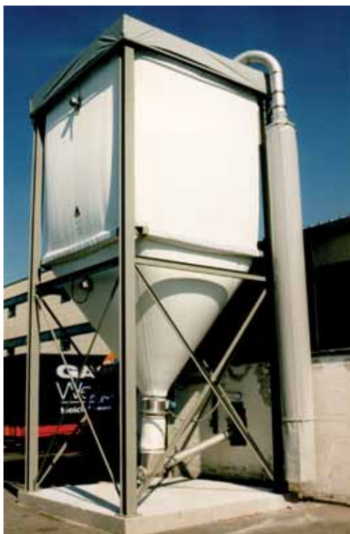
■ Aluminium-Silo 300 m 3 für Stärkepulver ■ Aluminium-silo 300 m 3 for starch powder
