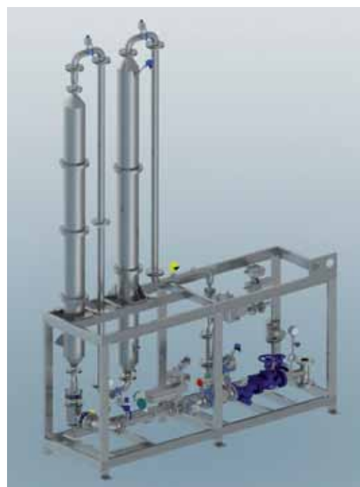
■ Kocherstation für Weizenstärke mit Teflon beschichteter Haltestrecke ■ cooking unit for wheat glue with Teflon coated conversion pipe
