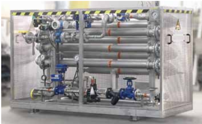
■ Stärkekocher Durchsatz 1000 - 6000 l/h ■ Starch cooking unit Capacity 1000 - 6000 l/h
